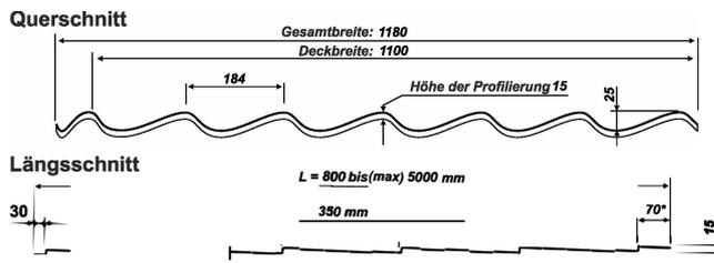
\* Bei Abmessung der hinteren Überlappung unter 70 mm hat die Blechtafel keine letzte Vorpprägung mehr.
